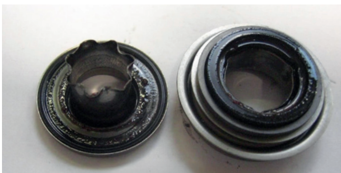
Zanieczyszczenia z układu chłodzenia w pierścieniu uszczelniającym pompy cieczy
